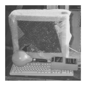
eingesetzt, die drei orthogonal zueinander angeordnete Meßspulen enthält. Die Sonde ist aber zu klein  $(d_{Spule} < 7cm)$ , um strikt TCO-konform zu sein. Zudem ist der obere Meßbereich auf 30 Hz - 30 kHz anstatt der vorgeschriebenen 2 - 400 kHz eingeengt.
