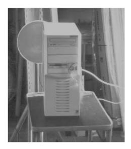
entsprechend der TCO gemessen. Dabei waren die Abschirmung bzw. das Gehäuse und die Sonde über denselben Erdungspunkt geerdet, um systematische Meßfehler wie elektrostatische Aufladungen oder durch Erdschleifen zu verhindern. Für die Messung der Magnetfelder wurde eine Meßsonde
