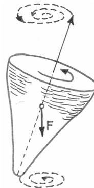
Fuß des Kreisels ist nicht spitz. Durch das Abrollen auf der Unterlage (Reibung) wird die Präzession beschleunigt. (vgl. Gyroskop Bild d)
